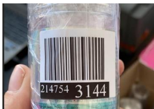
Лишние поля справа. Этикетку на цилиндрическую поверхность нужно клеить вдоль цилиндра (в примере на фото, этикетку можно повернуть на 90 градусов). В таком «изогнутом» виде этикетка будет очень плохо читаться сканером.
